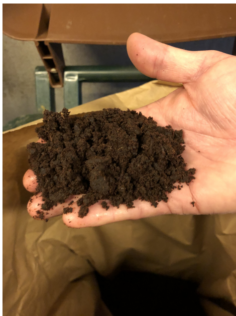
Figur 8: Den pulverliknande massa som återstår av matavfallet efter torkning i torkningsmaskin (Foto: B. von Bahr).
