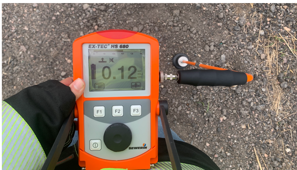
Figur 4. Bild från hur avläsningen av metankoncentrationen såg ut vid en mätning. Gas sugts upp och in i analysinstrumentet, där metankoncentrationen presenteras på skärmen. Bild: ©Linn Möller 2022.
